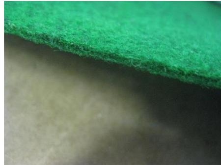
De fibra corta, de 3-5 mm de espesor, que marque 3 o más la lectura del sensor de color EV3 en modo de Luz Reflejada.
